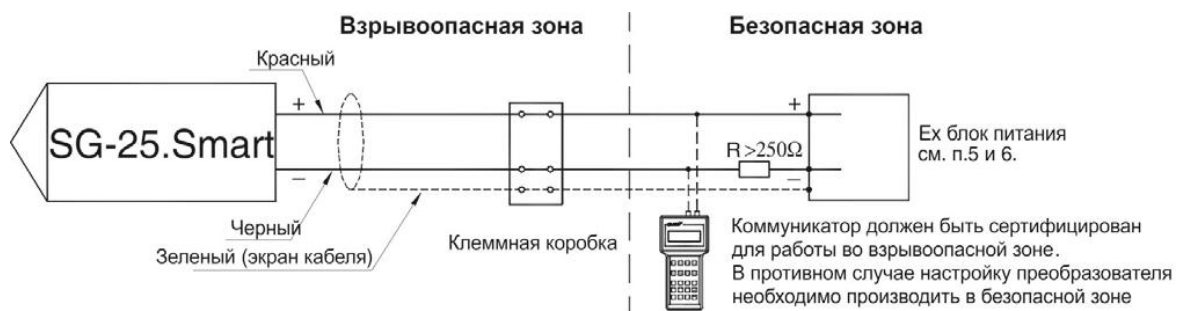
Рисунок 4 – Схема электрических подключений преобразователей модификаций PC-SG-25.Smart, PC-SG-25S.Smart в Ex исполнении
